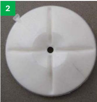
Das eingesetzte PCM-Element „Axiotherm Makroverkapselung für Hybridspeicher“ (Innenvolumen: 335 cm<sup>3</sup>, Durchmesser 180 mm, thermische Speicherkapazität im geplanten Temperaturbereich etwa 13 Wh pro Element) befüllt mit dem eigens entwickelten „Paraffin ATP 12“.
