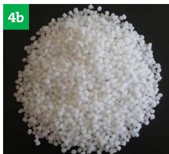
Versuchs-/Messstand (links), PCM-Granulat PK 52 (oben), theoretisch erreichbare Austrittstemperaturen eines Energiespeichers auf PCM-Basis (rechts)
